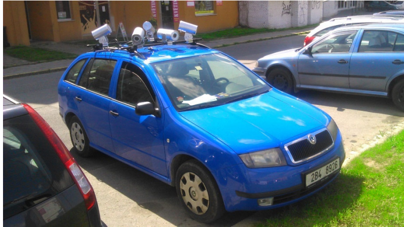
Obrázek 34 Vozidlo pro automatizovanou detekci parkujících vozidel
