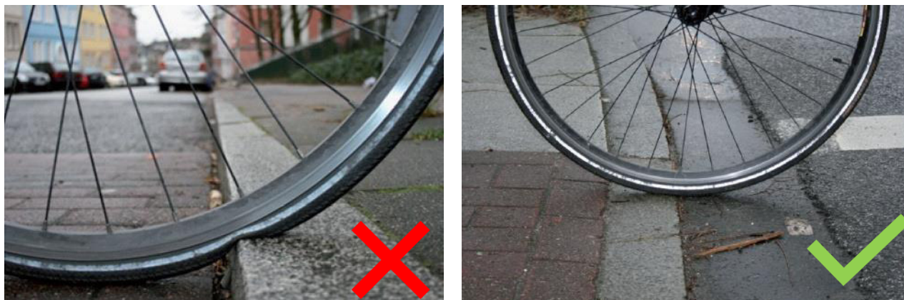
Obrázek 25 Působení obrubníku na kolo bicyklu (zdroj: cyklodoprava.cz)
